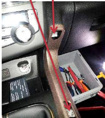
1.b. Déclipser les côtés de la console pour retirer les vis
