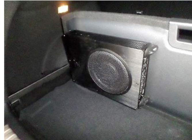
Remarque : Le caisson se positionne sous le faux plancher à l'arrière gauche.
