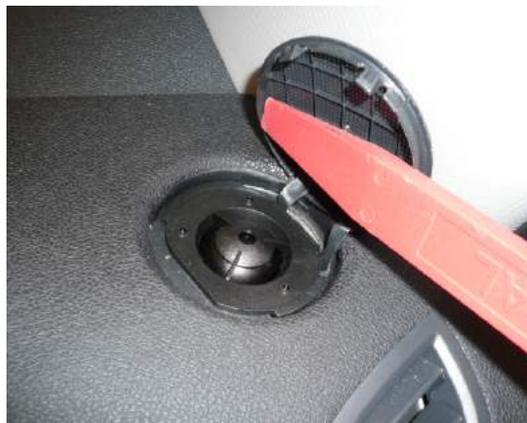
**2.b. Si il n'y a pas de tweeter d'origine, retirer la pièce prédécoupée à l'aide d'un tournevis**
