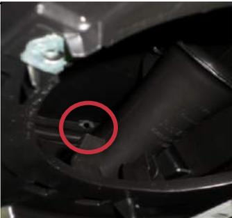
*En bas du support afin de permettre l'écoulement de l'eau qui pourrait s'introduire suite au perçage*
