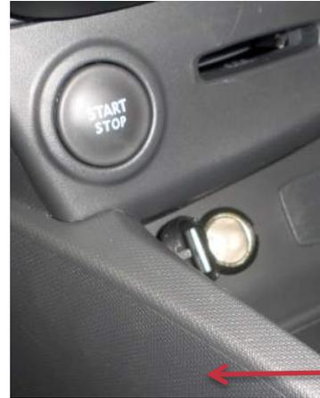
2. Pour accéder à la connectique il faut déclipser le côté gauche de la console.
