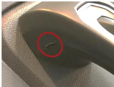
a.2 Insérez l'outil dans l'encoche pour déclipser la poignée de maintien.
