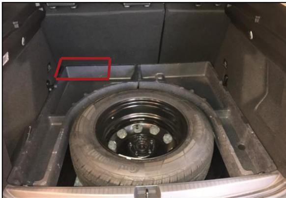
d. Partie du coffre à retailler avant montage du caisson.
