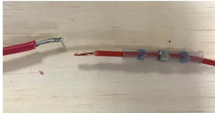
c. Utilisez un pistolet thermique pour chauffer le manchon à sertir.
